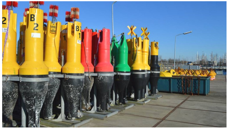
Kunststofbetonning, klaar om geplaatst te worden, op de kade in Lauwersoog RIJKSWATERSTAAT
