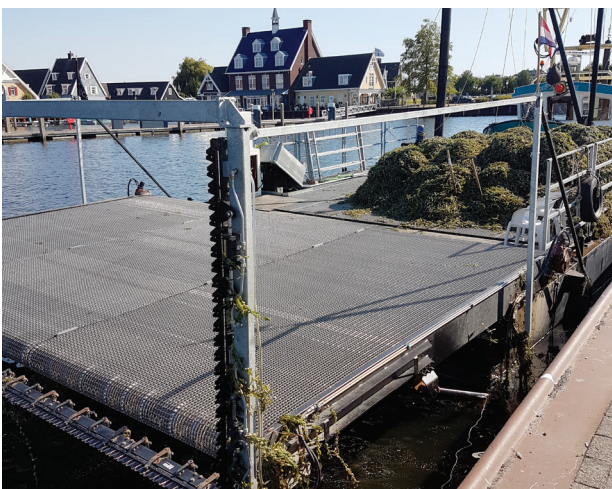
maaiplak met messen, transportband en opvangbak
