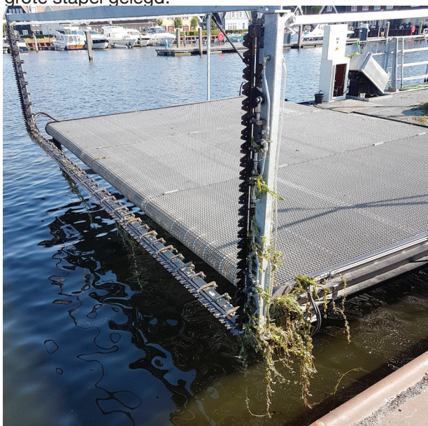
maaiplak met messen en transportband
