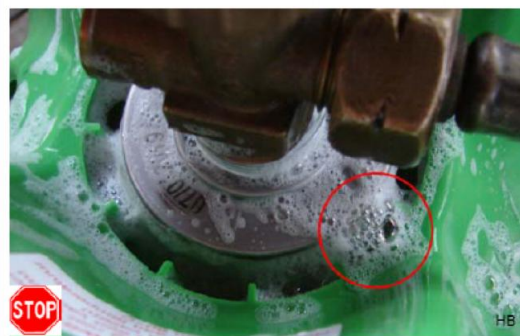
De klacht was dat de fles zo snel leeg was. Afsoppen is wel degelijk nodig. In de cirkel zie je het borrelen
