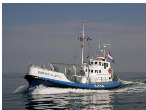
Naoorlogse 'all weather' havenreddingboten 1951 (type Carlot, lengte 20,37 m. 5 stuks). Operationele gebruiksduur van dit type: 49 jaar .
