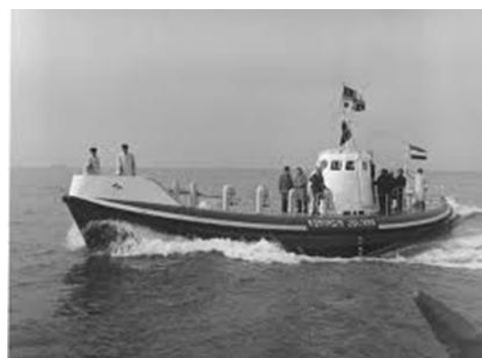
Havenreddingboot van 'de Zuid' Koningin Juliana met dezelfde type aanduiding, 1963 (lengte 21,05 m. 3 stuks) Operationele gebruiksduur van dit type: 43 jaar .
